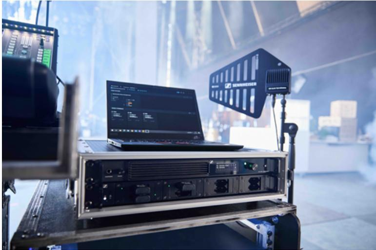
Toute une production, micros et retours in-ear compris, dans une unité de rack 19". Sous la Spectera Base Station, une station de charge en rack L 6000 avec modules de recharge pour batterie lithium-ion rechargeable BA 70. Spectera utilise les mêmes batteries que les systèmes Evolution Wireless Digital
